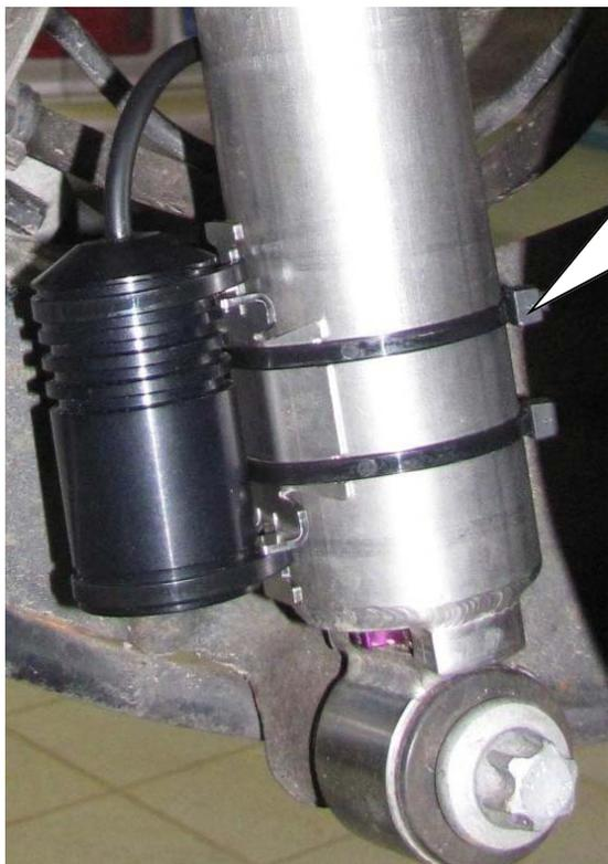
Stilllegung am Dämpfer mit dem Klebeband und Kabelbinder 4,8mm x 290mm befestigen.
