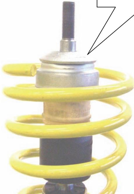
Stützlager komplett mit allen Serienteilen auf das Federbein aufsetzen (siehe Bild), Federanschlag des Gummiringes beachten. Das Anzugsdrehmoment der Kolbenstangenbefestigung beträgt 60 Nm. Die Montagehinweise zum Einbau des Federbeines in das Fahrzeug, sowie die Anzugsdrehmomente der Federbefestigung, entnehmen Sie bitte den Unterlagen des Fahrzeugherstellers.
