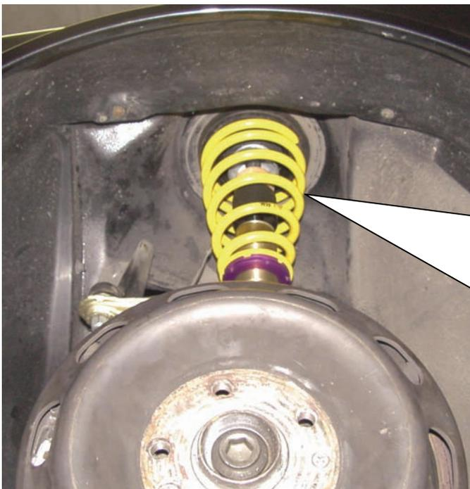
Nach dem Einbau des Federbeins in das Fahrzeug sowie nach jeder Korrektur der Fahrzeughöhe ist die Feder auf richtigen Sitz sowie die richtige Positionierung zu prüfen. Auf der linken Fahrzeugseite muss das obere Ende der Feder wie im Bild zu sehen 45° schräg zur Fahrzeugaußenseite Richtung Fahrzeugheck zeigen. Auf der rechten Fahrzeugseite muss das obere Ende der Feder 45° schräg zur Fahrzeugaußenseite Richtung Fahrzeugfront zeigen.
