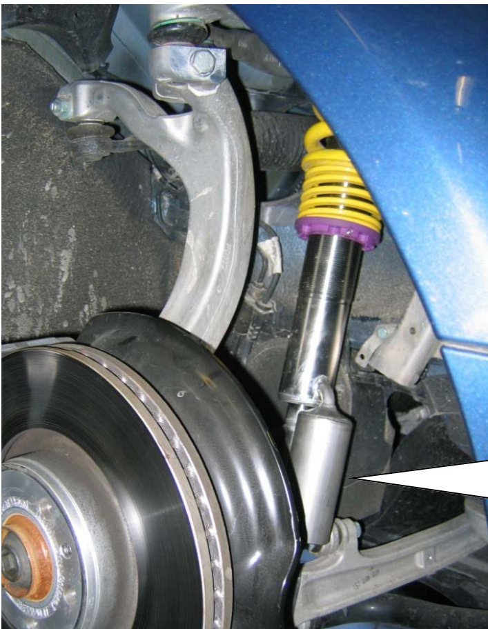
Bei Dämpferausführungen mit Druckausgleichsbehälter ist dieser, wie auf dem Bild zu sehen, zur Fahrzeugvorderseite zu montieren. On damper versions with compression balancing case, mount the case in the position to the front side as shown on the picture.
