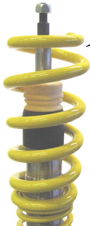
Angeliefertes Federbein. Supplied strut.
