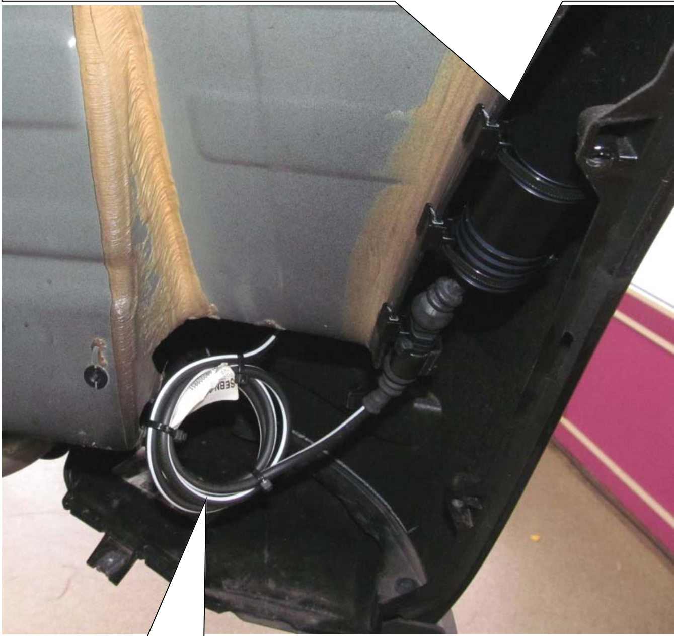
Original Kabel mit Kabelbindern befestigen. Fix the OEM wire with cable ties.
