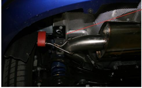
. THE LEFT HAND SIDE REAR HANGER FOR THE REAR SILENCER NEEDS TO BE TAKEN OFF AND ROTATED 180° AND RE-FITTED AS SHOWN IN THE FITTING PICTURE. THEN YOU CAN START TO ASSEMBLE THE SCORPION SYSTEM.
