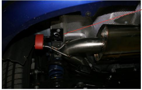
THE LEFT HAND SIDE REAR HANGER FOR THE REAR SILENCER NEEDS TO BE TAKEN OFF AND ROTATED 180° AND RE-FITTED AS SHOWN IN THE FITTING PICTURE. THEN YOU CAN START TO ASSEMBLE THE SCORPION SYSTEM.
